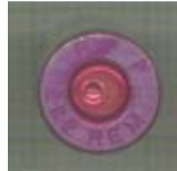
.222 Rem , 4810 bar, 70000 psi Keine Anzeichen zu hohen Druckes zu sehen
