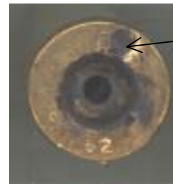
9,3 x 62, 5070 bar, 73500 psi, abgescherte Marke der Ausstoßerbohrung, Hülsenboden und Zündglocke gedehnt und Zündhütchen herausgefallen
