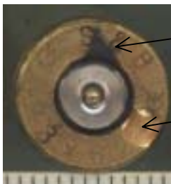
9,3 x 62, 5070 bar, 73500 psi, abgescherte Marke der Ausstoßerbohrung zu sehen, Zündhütchen flach mit Stoßbodenwerkzeugspuren, Zündglocke erweitert, Gasaustritt an der Ringfuge
